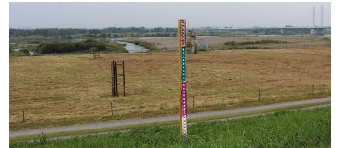
利根川八斗島地点の量水標
