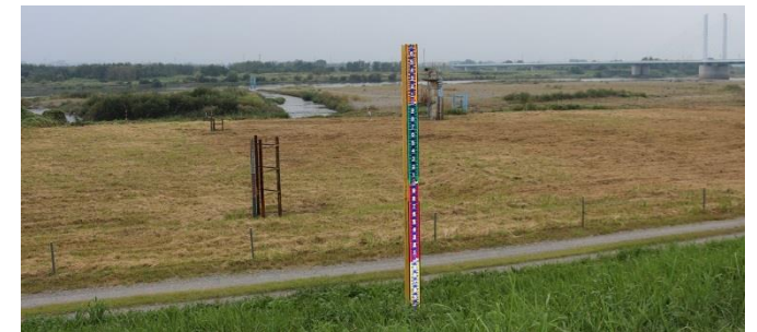
利根川八斗島地点の量水標
