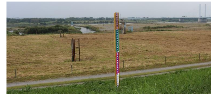
利根川八斗島地点の量水標
